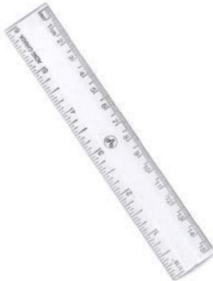
Mistar atau penggaris adalah alat ukur panjang yang biasa digunakan untuk mengukur panjang dan lebar benda.
