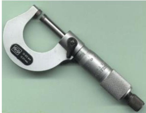
Mikrometer sekrup adalah alat ukur yang difungsikan untuk mengukur diameter benda tipis, misalkan plat.
