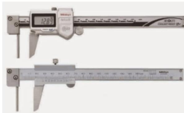
**Jangka sorong** sering digunakan untuk mengukur diameter bola kecil, tebal uang logam, maupun diameter dalam tabung.
