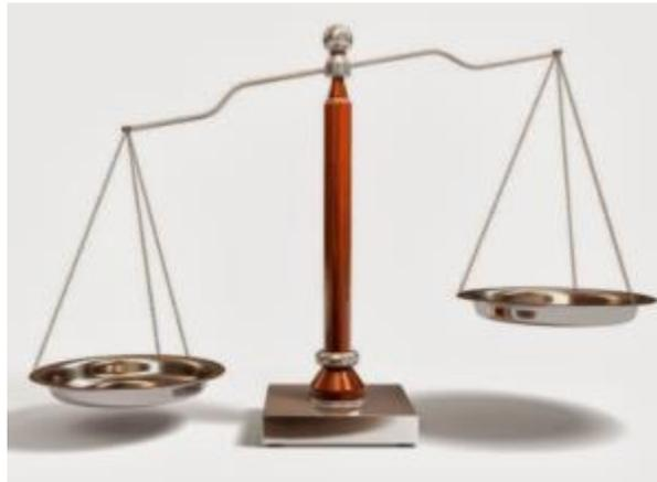
Neraca jenis ini akan banyak terlihat di toko-toko emas, karena digunakan untuk mengukur massa emas. Pada **neraca analitis dua lengan**, terdapat dua lengan dengan wadah kecil dari logam untuk menimbang.
