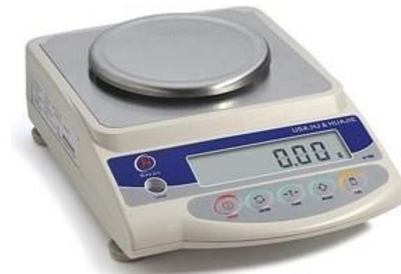
Neraca digital merupakan alat ukur massa yang sering ada di dalam laboratorium untuk menimbang bahan yang akan digunakan dalam praktikum.
